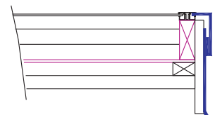
Ortgang ohne Verschaltkanal mit Ortgangbrett
